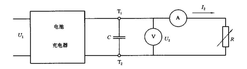
U<sub>1</sub>一电源电压;U<sub>2</sub>一输出电压;I<sub>2</sub>一输出电流;A一平均电流安培表; V一平均电压伏特表;R一可变电阻器;T<sub>1</sub>和 T<sub>2</sub>一电池充电器输出电路的端子;C一电容器,F。其容量由下式计算:
